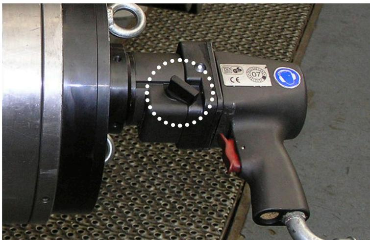
**alkitronic® CLS2**, 2-Gang Drehmoment-schrauber. Mechanisch umschaltbar vom Schnellgang in den Kraftgang.
